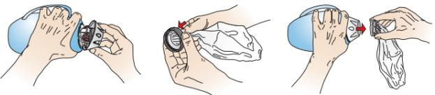
Incliner la flasque transparente sur la tétine O<sub>2</sub>. Retirer la flasque du réservoir O<sub>2</sub> à travers la fente de l'écrou. Pousser la flasque environnant l'ouverture inférieure dans l'écrou. Attraper le fil du corps de valve avec l'écrou du réservoir et le serrer.
