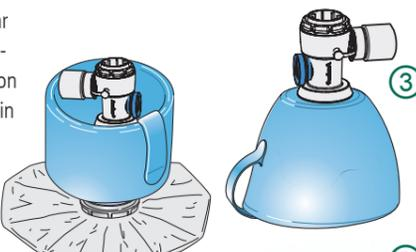
Pour un stockage compact (par exemple dans une valise de réanimation), la valve d'admission peut être enfoncée à mi-chemin dans le ballon.
