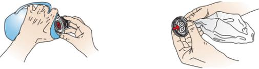
Pousser le corps de valve hors de l'insufflateur. Retirer l'écrou du réservoir O<sub>2</sub>.
