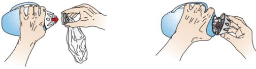
Dévisser l'écrou qui sécurise le réservoir O<sub>2</sub>. Retirer la
