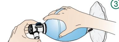
Fermer le raccord patient avec un doigt et compresser fermement le ballon pour vérifier que la valve est correctement montée et étanche. Effectuer le test juste avant chaque utilisation de l'insufflateur, faute de quoi la ventilation pourrait être réduite ou nulle.
